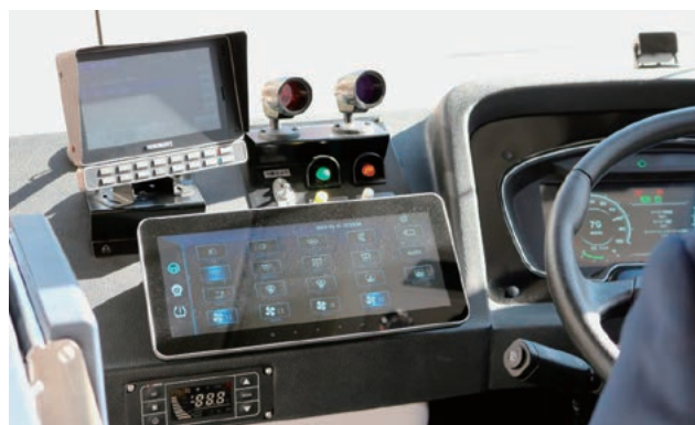
タッチパネルにまとめられたスイッチ類 (写真提供:伊予鉄バス)
